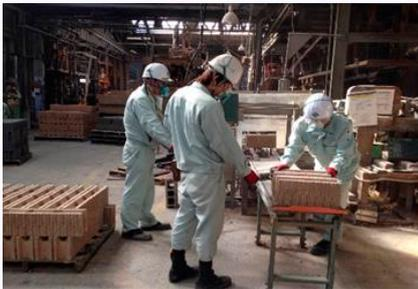
化粧ブロックは、製品に凹凸の加工を施した物で、加工後、検品整列作業、印字作業、手動でパレット積み作業を合計3名で行っていた。重量物かつ壊れやすい製品であるため慎重に作業を行う必要があり、作業するには過酷な作業であると共に生産性も低かった。
