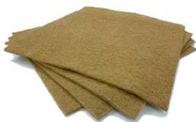
グラウフィルターは、腐食性ガスを吸着・化学結合する特殊な鉱物を含浸させたもので、硫化水素、メチルカブタンなどの酸性ガス、ならびにアンモニア、アミンなどの塩基性ガスの同時吸着が可能な高機能フィルターです。
