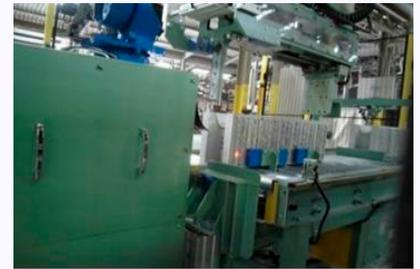
検品者1名で、自動印字、自動パレット積みを行う。作業のみで、重労働から解放された。自動印字機は曲検品者は、検品後搬送ラインに送る面への印字をインクジェット式で実現した。ロボットハンドは、製品特長を総合的に考慮し、掴み方式で最大サイズから最小サイズ製品を段取り替え無に対応でき、意匠面の把持を最小限にし、落下防止機能を備えることで、ロボット化(高速化)が実現した。高速化により25%の生産性の向上が図れたと共に、重労働の排除や危険作業の排除が実現した。
