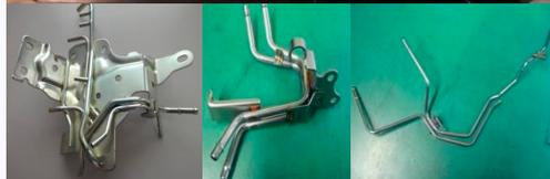
三次元パイプ形状物の曲面に精密加工
