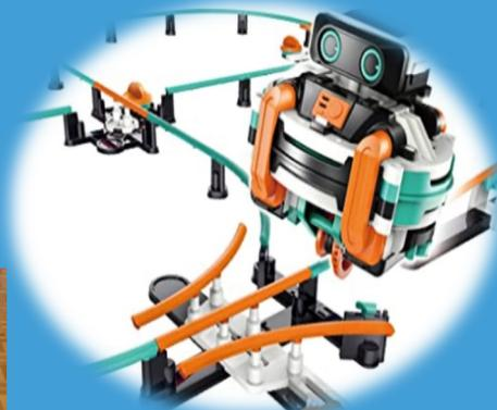
ジャイロ効果を利用し、一つのタイヤでレールから落ちずに走るロボットを製作しました。
